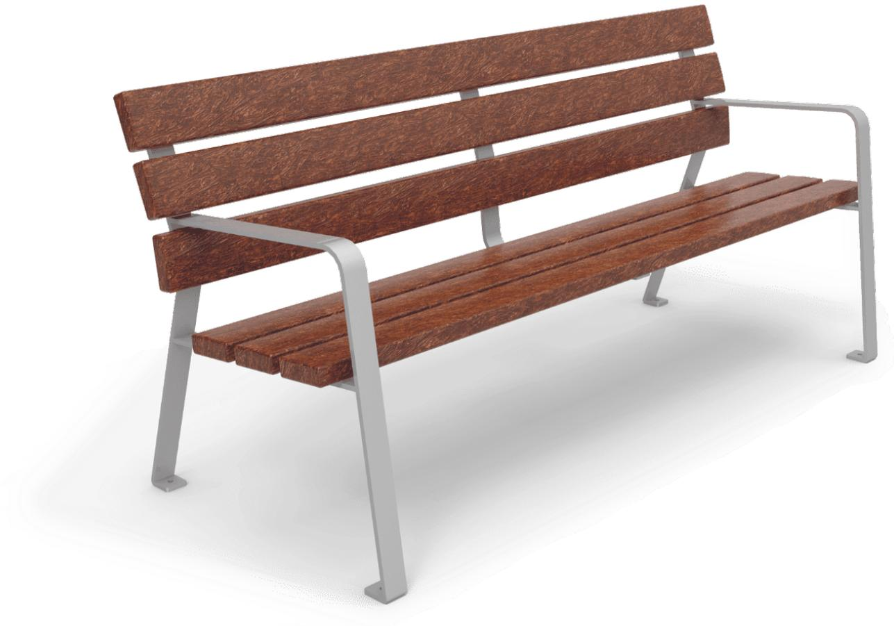
Pies de acero de 50x8 mm con tratamiento Ferrus. Perfiles de polímeros reciclados de sección 110x40x1800mm. Ecológico, proviene de producto reciclado y a la vez es reciclable. No requiere mantenimiento. No se astilla ni se agrieta, tampoco se pudre ni se reseca. Resistente a la humedad. Alta resistencia a las inclemencias. Resistente y duradero.
