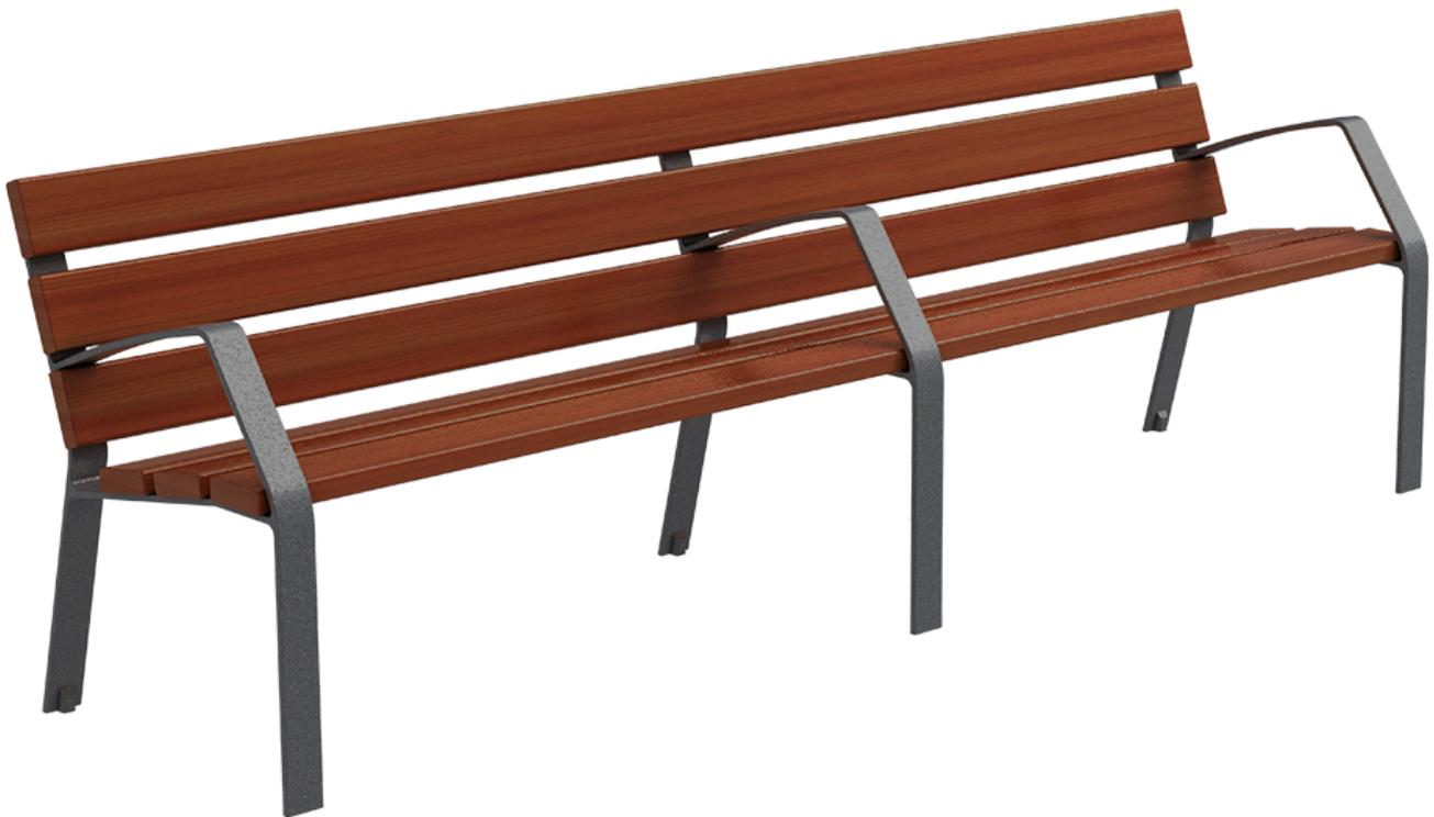
**Basic BCN** está fabricado con pies de fundición dúctil tratado con Ferrus, un proceso protector del hierro, que garantiza una óptima resistencia a la corrosión. El tratamiento Ferrus se compone de tres capas que se aplican después de limpiar toda la suciedad y las impurezas mediante granallado y consiste en un baño electrolítico, seguido de una capa de imprimación epoxi y un último recubrimiento de pintura poliéster en polvo color Martelé.
