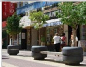
**Material:** Fabricado en hormigón armado B500S e hidrofugado en masa de 950 kg de peso con acabado liso o decapado colores a elegir entre blanco, gris, granítico, pigmentado, colores con pintura bicomponente
