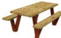
**Pies tubulares de acero corten de 50 x 100 mm. Tablones de sección 210 x 50 mm en madera de pino tratada en autoclave vaciopresión clase 4 contra la carcoma, termitas e insectos**
