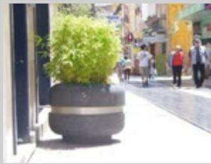
**Material:** Fabricado en hormigón armado B500S e hidrofugado en masa de 455 kg de peso con acabado liso o decapado colores a elegir entre blanco, gris, granítico, pigmentado, colores con pintura bicomponente
