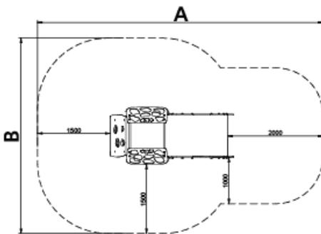
**Estructura, Metal:** Postes Ø35mm acero inoxidable AISI304, con gran resistencia a la abrasión, la corrosión y la intemperie. La superficie deslizante del tobogán es de acero inoxidable pulida AISI304 de 2 mm de grosor y está curvada, ondulada y modelada en una sola pieza.
